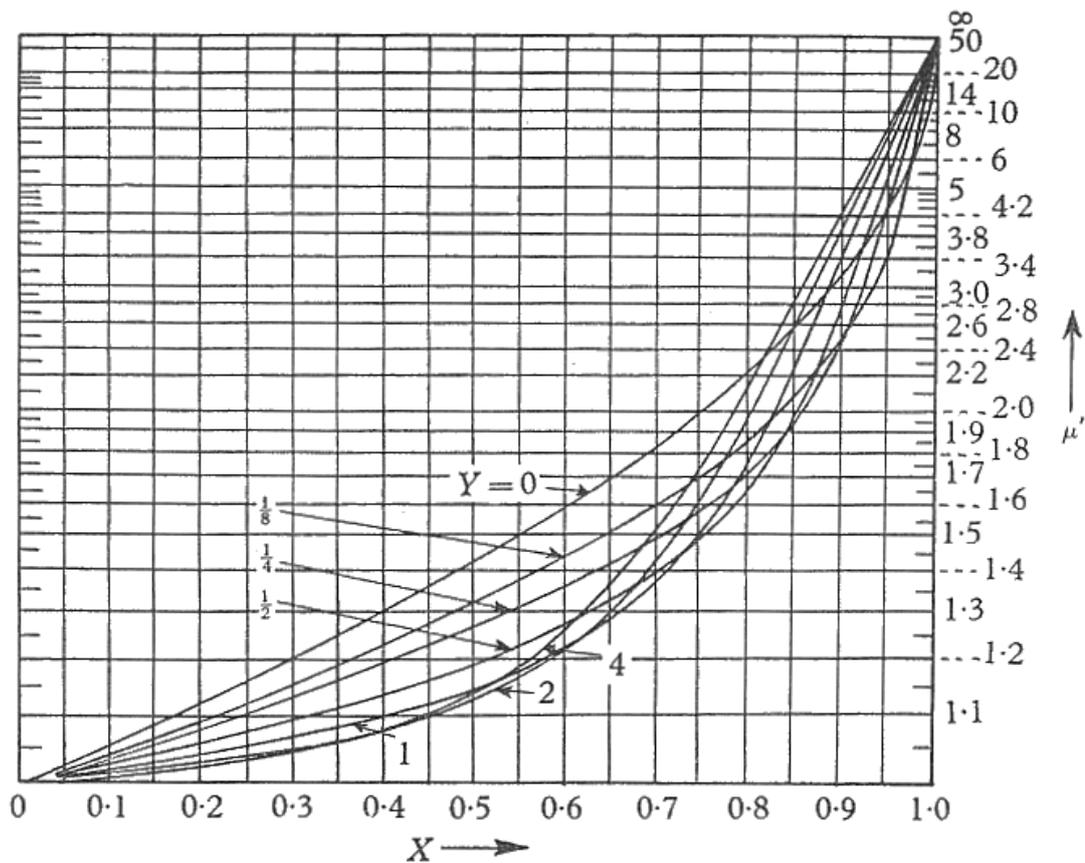
**Figura 7.1** Curve che illustrano come varia, per il raggio ordinario, l'indice di rifrazione di gruppo  $\mu'$  in funzione di  $X$ , per differenti valori di  $Y$  e per una direzione di propagazione che forma un angolo di  $23^\circ 16'$  con il campo magnetico esterno.
