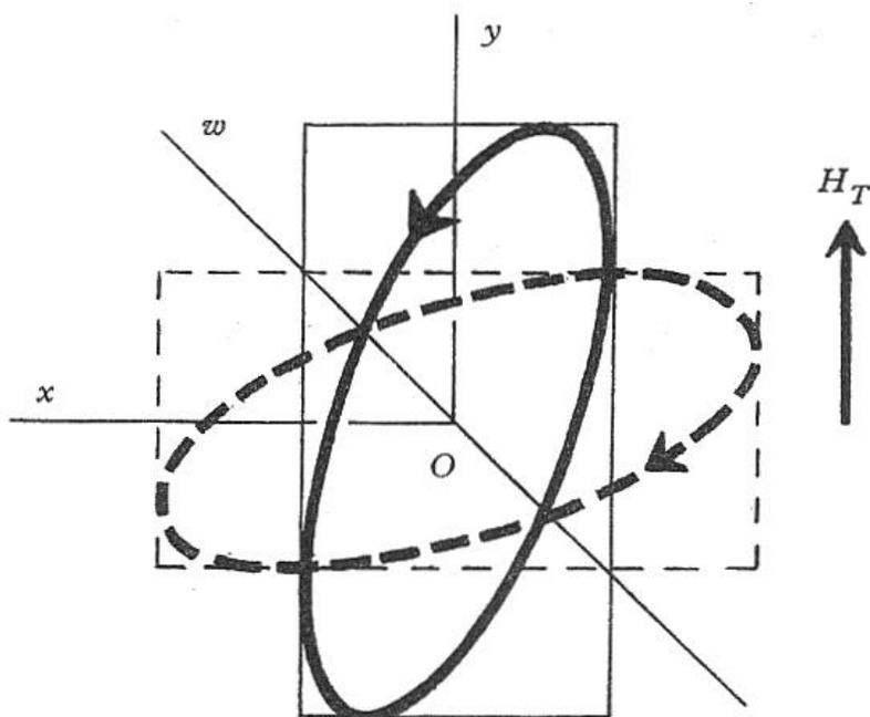
**Figura 4.2** Le polarizzazioni del campo elettrico nel piano del fronte d'onda.  $Ox$  e  $Oy$  sono le direzioni principali e la proiezione del campo magnetico esterno è lungo  $Oy$ . La normale al fronte d'onda è entrante nel foglio lungo  $Oz$ . L'ellisse dell'onda ordinaria è rappresentata a tratto continuo mentre l'ellisse dell'onda straordinaria è rappresentata a tratto tratteggiato.
