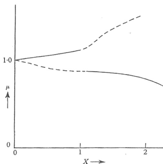
**Figura 4.4** Valori di  $\mu(X)$  calcolati tramite la (1.49) per il caso in cui  $Y=3$ ,  $Z=0.3$ ,  $\theta=19^\circ$ ,  $|\omega_c/v|=0.52$ . La linea a tratto continuo si riferisce al segno superiore, mentre quella tratteggiata al segno inferiore.
