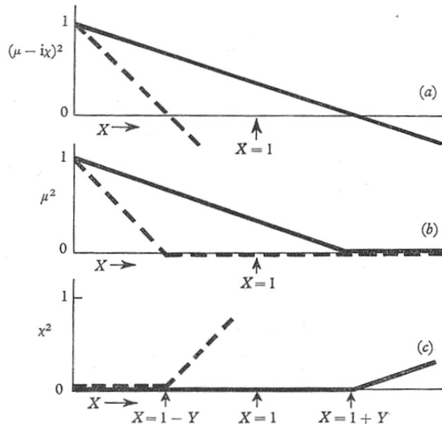
**Figura 3.2** Propagazione longitudinale con  $Y < 1$  ( $Y = 1/2$ ).
