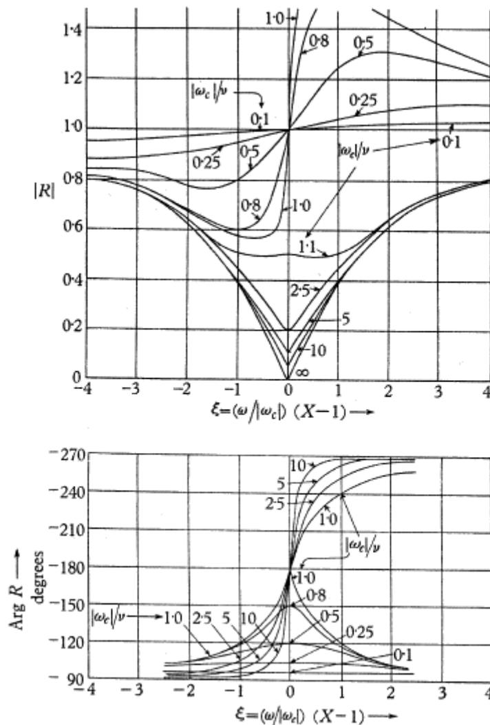
**Figura 4.5**  $|R(X)|$  e di  $\arg R(X)$ , per diversi valori di  $|\omega_c/v|$ , per un'onda ordinaria nel caso in cui  $\omega_c$  è negativo. Sulle ascisse è graficata la quantità  $\xi = (\omega/\omega_c)(X-1)$ . Il punto  $\xi = 0$  corrisponde a  $X = 1$  e le polarizzazioni sono quelle già discusse in Figura 4.3. Valori negativi di  $\xi$  corrispondono a valori di  $X < 1$  e  $\xi = |\omega/\omega_c|$  corrisponde a  $X = 0$ .
