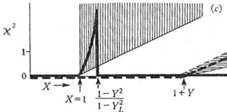
**Figura 3.8** Caso generale per  $Y > 1$  ( $Y=2$ ). La curva in grassetto si riferisce ad una propagazione corrispondente ad un angolo  $\theta = 45^\circ$ .
