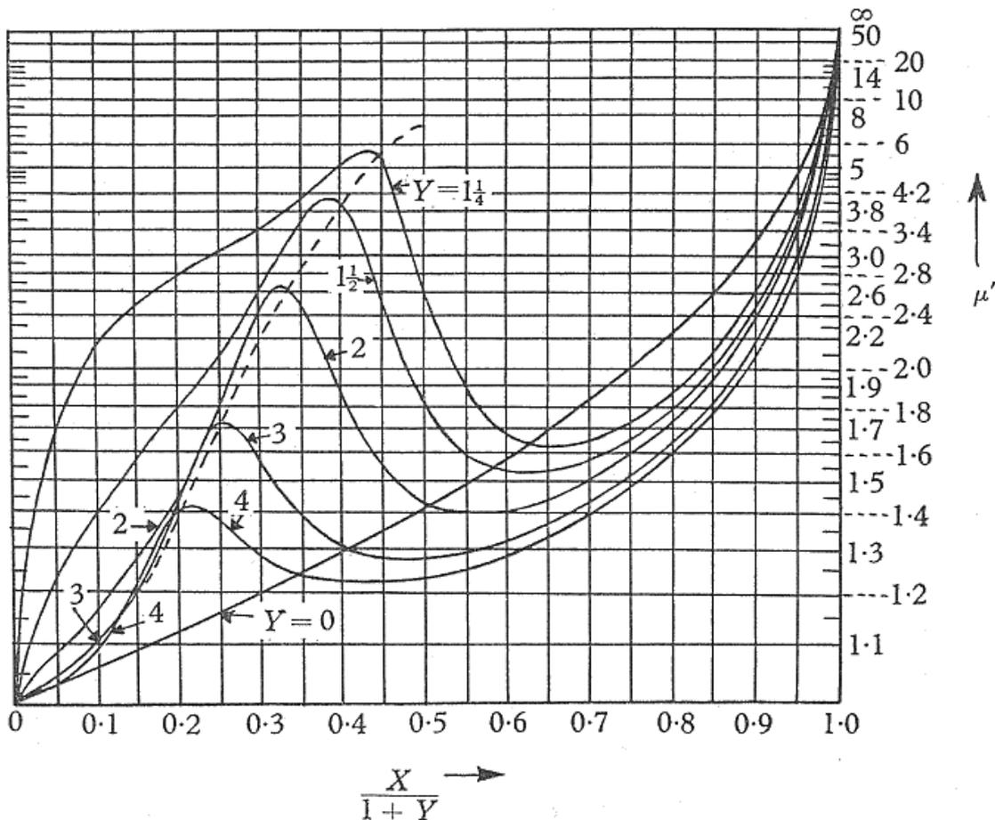
**Figura 7.3** Curve che illustrano come varia, per il raggio straordinario, l'indice di rifrazione di gruppo  $\mu'$  in funzione di  $X/(1+Y)$ , per differenti valori di  $Y > 1$ . I massimi delle curve giacciono vicino la linea tratteggiata che rappresenta i valori di  $\mu'(X=1)$ .
